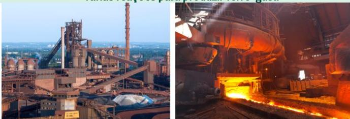
O coque é gaseificado substoichiometricamente em alto-forno - e o minério de ferro é reduzido. O ferro-gusa líquido e a escória se acumulam na área inferior do alto-forno.
