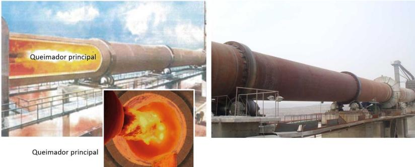
Figura 188: Forno rotativo. Fonte: Notas de Aulas, 2023.
