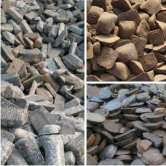
O termo "ferro-gusa" deriva da velha maneira de lidar com o ferro fundido. Ele era escoado diretamente do forno para dentro de canais abertos que se alimentavam em inúmeros canais curtos em ambos os lados, levando uma ligeira semelhança a uma porca que mamava leitões de ferro.
