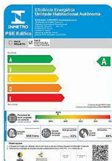
Figura 137: Eficiência energética em edificação (PBE Edifica: Programa PROCEL Edifica).
