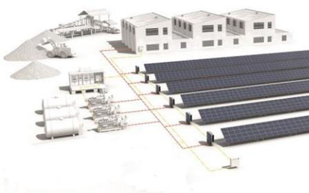
O objetivo: usar o máximo possível de energia solar em vez de diesel. O conceito de usar o PV como parte do sistema híbrido acaba de ser iniciado.
