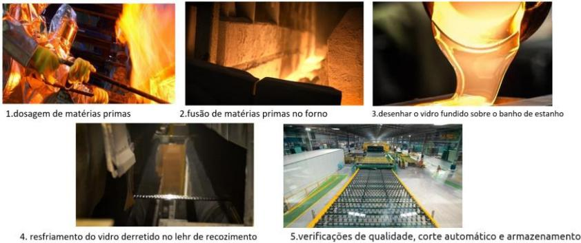
Figura 195: Processo de fabricação de vidro. Fontes: Notas de Aulas, 2023.
