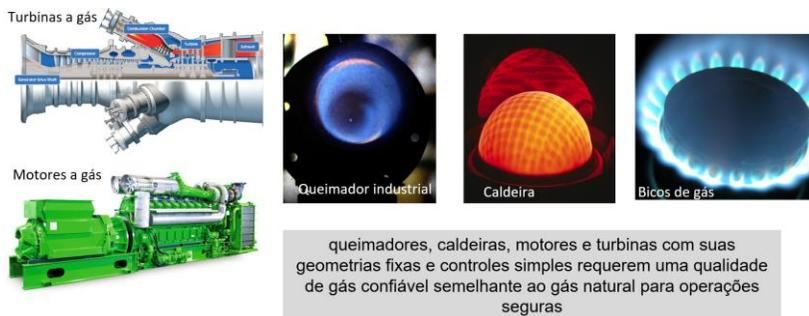
Figura 181: Aparelhos a gás natural podem não gostar muito de hidrogênio. **Os consumidores exigem o combustível certo para o funcionamento estável e a combustão.** Fonte: Notas de Aulas, 2023.
