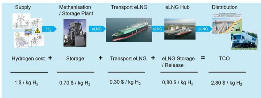
Figura 37: Avaliação das cadeias de suprimento de hidrogênio: LOHC Valores numéricos exemplares para orientação (ordem de grandeza); é necessária uma avaliação específica para cada caso. Fonte: Bank, R., Power-to-X como base para a logística energética global, Deutscher Ingenieurtag, VDI, 2021
