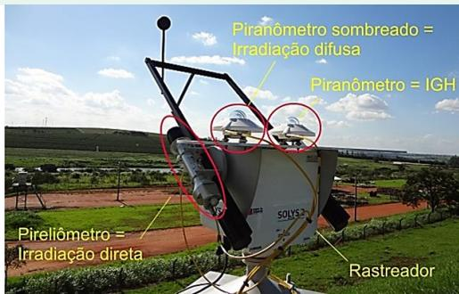
Figura 87: Exemplo de Estação Solarimétrica – Usina Solar Tanquinho. Fonte: elaboração própria
