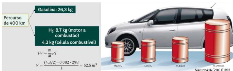
Figura 23: Volume de hidrogênio necessário para o uso em veículos leves.
