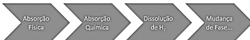
A fragilização por  $H_2$  é um fenômeno no qual átomos e moléculas de  $H_2$  são absorvidos e interagem com os átomos e grãos do metal, promovendo alterações em sua composição e estrutura, criando tensões internas, reduzindo a ductibilidade e a resistência à tração, e provocando o surgimento de rachaduras que comprometem a integridade do material.
