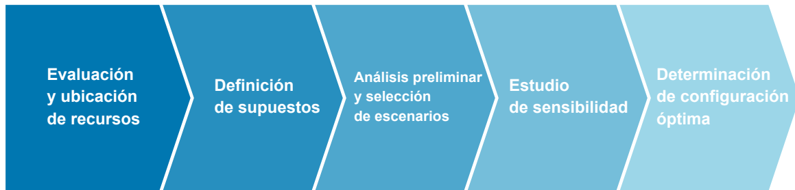
Figura 19. Metodología para obtener un diseño y dimensionamiento óptimo de la planta Power-to-X
