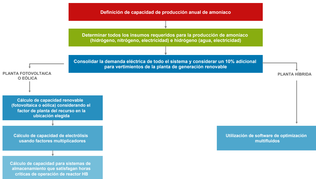
Figura 12. Metodología general para dimensionamiento de sistema Power-to-Ammonia
